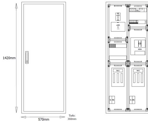
AVKNA250-2-9-360 V-Automatenverteiler, AVK, BxHxT = 570x1420x360 Schutzklasse II, IP54, RAL 7035, Aufputz Bestehend aus:Gehäuse, Einzeltür mit Schwenkhebel für PHZ, Flansche SF32 (oben) und SF39 (unten), 1x Geräteträger mit Feldabdeckungen PRL best. mit
