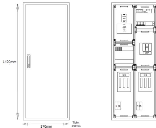
AVKNA150-2-9-360 V-Automatenverteiler, AVK, BxHxT = 570x1420x360 Schutzklasse II, IP54, RAL 7035, Aufputz Bestehend aus:Gehäuse, Einzeltür mit Schwenkhebel für PHZ, Flansche SF32 (oben) und SF39 (unten), 1x Geräteträger mit Feldabdeckungen PRL best. mit
