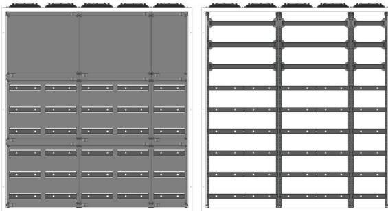
AVK5-9-400-PAutomatenverteiler, AVK, BxHxT = 1320x1420x400 Schutzklasse II, IP54, RAL 7035, Aufputz
