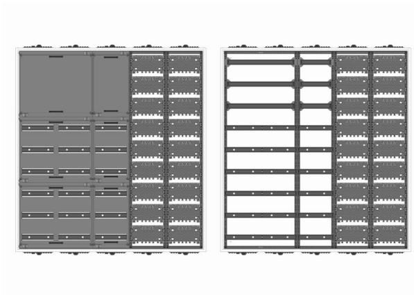
AVK5-9-230-M2 Automatenverteiler, AVK, BxHxT = 1300x1400x230 Schutzklasse II, IP54, RAL 7035, Aufputz
