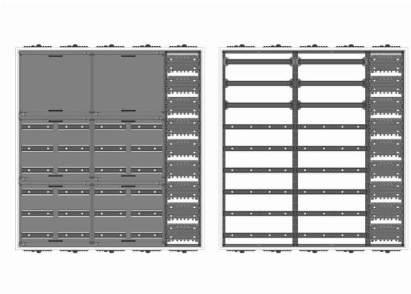
AVK5-9-210-M1 Automatenverteiler, AVK, BxHxT = 1300x1400x210 Schutzklasse II, IP41, RAL 9016, Aufputz
