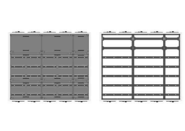
AVK5-7-230-S Automatenverteiler, AVK, BxHxT = 1300x1100x230 Schutzklasse II, IP54, RAL 7035, Aufputz
