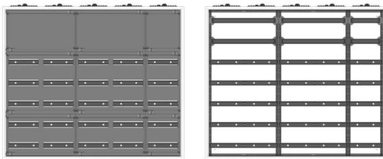
AVK5-7-210-S-PAutomatenverteiler, AVK, BxHxT = 1300x1100x210Schutzklasse II, IP41, RAL 9016, AufputzBestehend aus:Gehäuse, Doppeltür mit Drehriegel, Flansche NF1 (oben) und NF2 (unten), 2x Geräteträger 2-Feld breit 2/5 mit Feldabdeckungen PS, 1x Geräteträger 1-Feld breit 2/5 mit Feldabdeckungen PS
