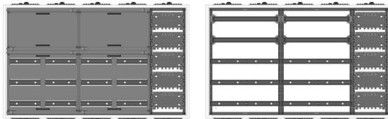
AVK5-5-230-M1 Automatenverteiler, AVK, BxHxT = 1300x800x230 Schutzklasse II, IP54, RAL 7035, Aufputz
