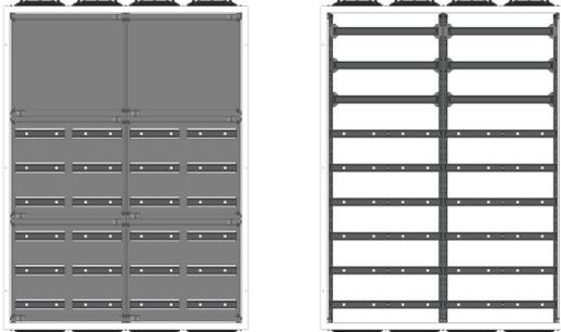
AVK4-9-360-PAutomatenverteiler, AVK, BxHxT = 1070x1420x360 Schutzklasse II, IP54, RAL 7035, Aufputz
