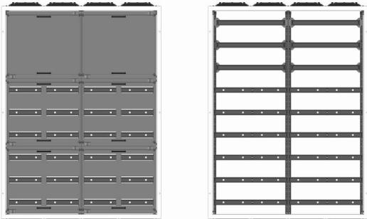
AVK4-9-300 Automatenverteiler, AVK, BxHxT = 1070x1420x300 Schutzklasse II, IP54, RAL 7035, Aufputz Bestehend aus: Gehäuse, Doppeltür mit Schwenkhebel für PHZ, Flansche SF35 (oben) und SF32 (unten), 2x Geräteträger 2-Feld breit 3/6 mit Feldabdeckungen PRL
