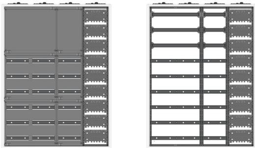
AVK4-9-210-M1-PAutomatenverteiler, AVK, BxHxT = 1050x1400x210Schutzklasse II, IP41, RAL 9016, AufputzBestehend aus:Gehäuse, Doppeltür mit Drehriegel, Flansche NF1(oben) und NF2 (unten), 1x Geräteträger 2-Feld breit 3/6 mit Feldabdeckungen PS, 1x Geräteträger 1-Feld breit 3/6 mit Feldabdeckungen PS, 1x Montageplatte 1-Feld breit
