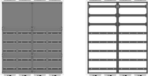
AVK4-8-210-PAutomatenverteiler, AVK, BxHxT = 1050x1250x210Schutzklasse II, IP41, RAL 9016, AufputzBestehend aus:Gehäuse, Doppeltür mit Drehriegel, Flansche NF1 (oben) und NF2 (unten), 2x Geräteträger 2-Feld breit 3/5 mit Feldabdeckungen PS
