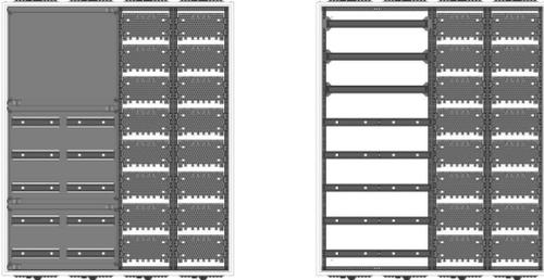
AVK4-8-210-M2-PAutomatenverteiler, AVK, BxHxT = 1050x1250x210Schutzklasse II, IP41, RAL 9016, AufputzBestehend aus:Gehäuse, Doppeltür mit Drehriegel, Flansche NF1 (oben) und NF2 (unten), 1x Geräteträger 2-Feld breit 3/5 mit Feldabdeckungen PS, 1x Montageplatte 2-Feld breit
