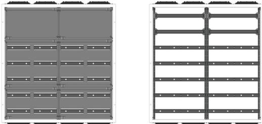
AVK4-7-360-PAutomatenverteiler, AVK, BxHxT = 1070x1120x360 Schutzklasse II, IP54, RAL 7035, Aufputz Bestehend aus: Gehäuse, Doppeltür mit Schwenkhebel für PHZ, Flansche SF35 (oben) und SF32 (unten), 2x Geräteträger 2-Feld breit 2/5 mit Feldabdeckungen PS
