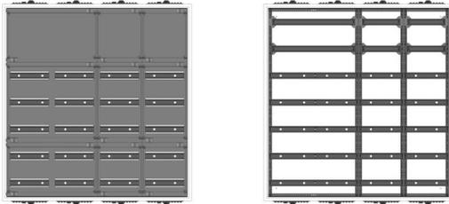
AVK4-7-230-S-PAutomatenverteiler, AVK, BxHxT = 1050x1100x230Schutzklasse II, IP54, RAL 7035, AufputzBestehend aus:Gehäuse, Doppeltür mit Schwenkhebel für PHZ, Flansche SF45 (oben) und SF41 (unten), 1x Geräteträger 2-Feld breit 2/5 mit Feldabdeckungen PS, 2x Geräteträger 1-Feld breit 2/5 mit Feldabdeckungen PS
