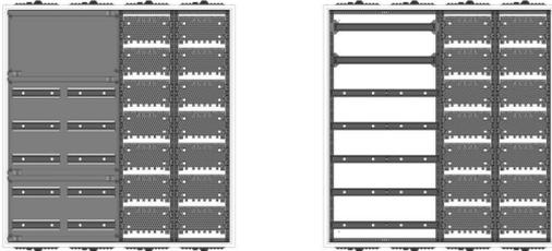
AVK4-7-230-M2-PAutomatenverteiler, AVK, BxHxT = 1050x1100x230Schutzklasse II, IP54, RAL 7035, AufputzBestehend aus:Gehäuse, Doppeltür mit Schwenkhebel für PHZ, Flansche SF45(oben) und SF41 (unten), 1x Geräteträger 2-Feld breit 2/5 mit Feldabdeckungen PS, 1x Montageplatte 2-Feld breit
