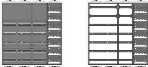
AVK4-7-210-M1-PAutomatenverteiler, AVK, BxHxT = 1050x1100x210Schutzklasse II, IP41, RAL 9016, AufputzBestehend aus:Gehäuse, Doppeltür mit Drehriegel, Flansche NF1(oben) und NF2 (unten), 1x Geräteträger 2-Feld breit 2/5 mit Feldabdeckungen PS, 1x Geräteträger 1-Feld breit 2/5 mit Feldabdeckungen PS, 1x Montageplatte 1-Feld breit
