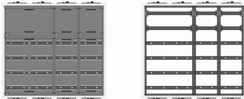
AVK4-6-230-S Automatenverteiler, AVK, BxHxT = 1050x950x230 Schutzklasse II, IP54, RAL 7035, Aufputz
