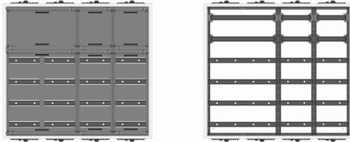
AVK4-6-210-S Automatenverteiler, AVK, BxHxT = 1050x950x210 Schutzklasse II, IP41, RAL 9016, Aufputz
