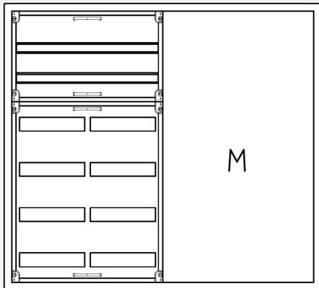
AVK4-6-210-M2-PAutomatenverteiler, AVK, BxHxT = 1050x950x210Schutzklasse II, IP41, RAL 9016, AufputzBestehend aus:Gehäuse, Doppeltür mit Drehriegel, Flansche NF1(oben) und NF2 (unten), 1x Geräteträger 2-Feld breit 2/4 mit Feldabdeckungen PS, 1x Montageplatte 2-Feld breit
