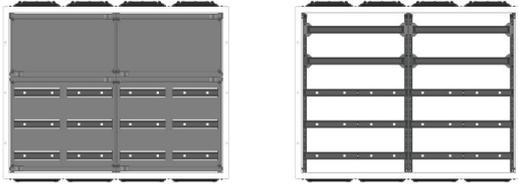
AVK4-5-500-PAutomatenverteiler, AVK, BxHxT = 1070x820x500 Schutzklasse II, IP54, RAL 7035, Aufputz Bestehend aus: Gehäuse, Doppeltür mit Schwenkhebel für PHZ, Flansche SF35 (oben) und SF32 (unten), 2x Geräteträger 2-Feld breit 2/3 mit Feldabdeckungen PS
