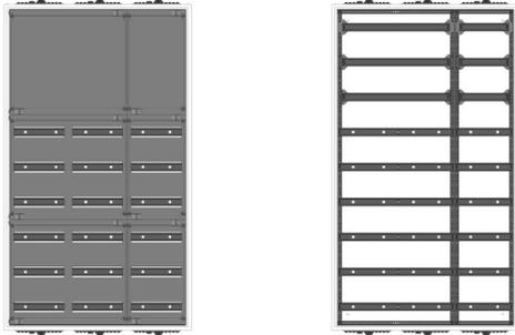
AVK3-9-230-S-PAutomatenverteiler, AVK, BxHxT = 800x1400x230Schutzklasse II, IP54, RAL 7035, AufputzBestehend aus:Gehäuse, Einzeltür mit Schwenkhebel für PHZ, Flansche SF45 (oben) und SF41 (unten), 1x Geräteträger 2-Feld breit 3/6 mit Feldabdeckungen PS, 1x Geräteträger 1-Feld breit 3/6 mit Feldabdeckungen PS
