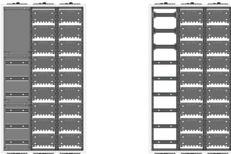
AVK3-9-210-M2-PAutomatenverteiler, AVK, BxHxT = 800x1400x210Schutzklasse II, IP41, RAL 9016, AufputzBestehend aus:Gehäuse, Doppeltür mit Drehriegel, Flansche NF1(oben) und NF2 (unten), 1x Geräteträger 1-Feld breit 3/6 mit Feldabdeckungen PS, 1x Montageplatte 2-Feld breit
