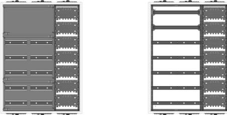
AVK3-7-210-M1-PAutomatenverteiler, AVK, BxHxT = 800x1100x210Schutzklasse II, IP41, RAL 9016, AufputzBestehend aus:Gehäuse, Doppeltür mit Drehriegel, Flansche NF1(oben) und NF2 (unten), 1x Geräteträger 2-Feld breit 2/5 mit Feldabdeckungen PS, 1x Montageplatte 1-Feld breit
