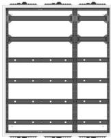
AVK3-6-230-S-PAutomatenverteiler, AVK, BxHxT = 800x950x230Schutzkasse II, IP54, RAL 7035, AufputzBestehend aus:Gehäuse, Einzeltür mit Schwenkhebel für PHZ, Flansche SF45 (oben) und SF41 (unten), 1x Geräteträger 2-Feld breit 2/4 mit Feldabdeckungen PS, 1x Geräteträger 1-Feld breit 2/4 mit Feldabdeckungen PS
