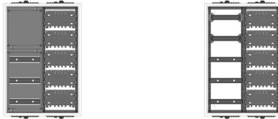
AVK2-5-230-M1-PAutomatenverteiler, AVK, BxHxT = 550x800x230Schutzklasse II, IP54, RAL 7035, AufputzBestehend aus:Gehäuse, Einzeltür mit Schwenkhebel für PHZ, Flansche SF45(oben) und SF41 (unten), 1x Geräteträger 1-Feld breit 2/3 mit Feldabdeckungen PS, 1x Montageplatte 1-Feld breit
