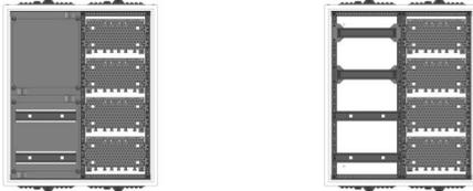
AVK2-4-230-M1-PAutomatenverteiler, AVK, BxHxT = 550x650x230Schutzklasse II, IP54, RAL 7035, AufputzBestehend aus:Gehäuse, Einzeltür mit Schwenkhebel für PHZ, Flansche SF45(oben) und SF41 (unten), 1x Geräteträger 1-Feld breit 2/2 mit Feldabdeckungen PS, 1x Montageplatte 1-Feld breit
