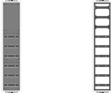
AVK1-9-230-PAutomatenverteiler, AVK, BxHxT = 300x1400x230Schutzklasse II, IP54, RAL 7035, AufputzBestehend aus:Gehäuse, Einzeltür mit Schwenkhebel für PHZ, Flansche SF45(oben) und SF41 (unten), 1x Geräteträger 1-Feld breit 3/6 mit Feldabdeckungen PS
