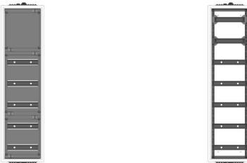
AVK1-7-210-PAutomatenverteiler, AVK, BxHxT = 300x1100x210Schutzklasse II, IP41, RAL 9016, AufputzBestehend aus:Gehäuse, Einzeltür mit Drehriegel, Flansche NF1(oben) und NF2 (unten), 1x Geräteträger 1-Feld breit 2/5 mit Feldabdeckungen PS
