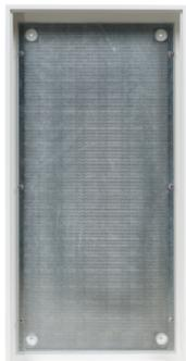
AVBM4-9-210 Automatenverteiler mit Montageplatte gelocht auf Rückwand, AVB, BxHxT = 1050x1400x210 Schutzklasse I, IP41, RAL 9016, Aufputz Bestehend aus: Gehäuse, Doppeltür mit Drehriegel, Flansche NF1 (oben) und NF2 (unten)
