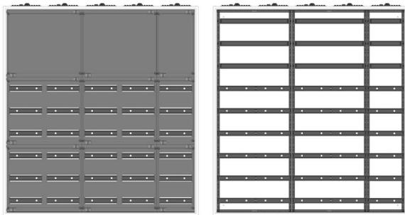
AVB5-9-230-S-PAutomatenverteiler, AVB, BxHxT = 1300x1400x230Schutzklasse I, IP54, RAL 7035, AufputzBestehend aus:Gehäuse, Doppeltür mit Schwenkhebel für PHZ, Flansche SF45 (oben) und SF41 (unten), 2x Geräteträger 2-Feld breit 3/6 mit Feldabdeckungen PS, 1x Geräteträger 1-Feld breit 3/6 mit Feldabdeckungen PS
