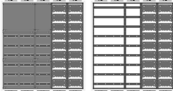
AVB5-9-230-M2-PAutomatenverteiler, AVB, BxHxT = 1300x1400x230Schutzklasse I, IP54, RAL 7035, AufputzBestehend aus:Gehäuse, Doppeltür mit Schwenkhebel für PHZ, Flansche SF45 (oben) und SF41 (unten), 1x Geräteträger 2-Feld breit 3/6 mit Feldabdeckungen PS, 1x Geräteträger 1-Feld breit 3/6 mit Feldabdeckungen PS, 1x Montageplatte 2-Feld breit
