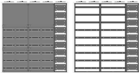
AVB5-9-230-M1-PAutomatenverteiler, AVB, BxHxT = 1300x1400x230Schutzklasse I, IP54, RAL 7035, AufputzBestehend aus:Gehäuse, Doppeltür mit Schwenkhebel für PHZ, Flansche SF45 (oben) und SF41 (unten), 2x Geräteträger 2-Feld breit 3/6 mit Feldabdeckungen PS, 1x Montageplatte 1-Feld breit
