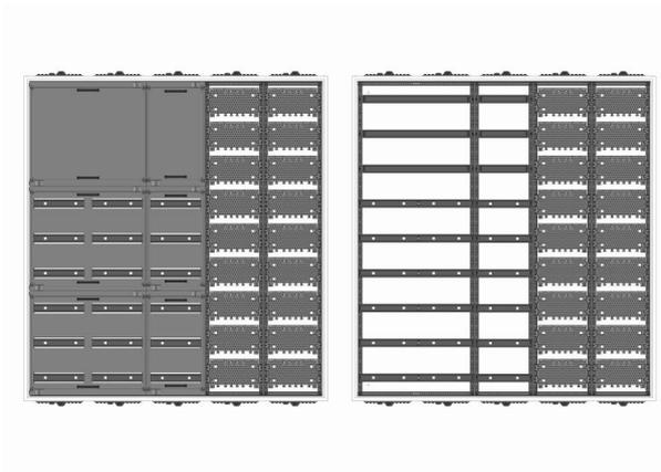
AVB5-9-210-M2 Automatenverteiler, AVB, BxHxT = 1300x1400x210 Schutzklasse I, IP41, RAL 9016, Aufputz
