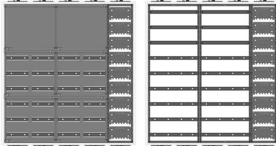
AVB5-9-210-M1-PAutomatenverteiler, AVB, BxHxT = 1300x1400x210Schutzklasse I, IP41, RAL 9016, AufputzBestehend aus:Gehäuse, Doppeltür mit Drehriegel, Flansche NF1 (oben) und NF2 (unten), 2x Geräteträger 2-Feld breit 3/6 mit Feldabdeckungen PS, 1x Montageplatte 1-Feld breit
