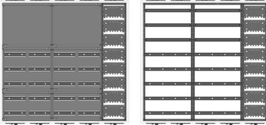
AVB5-8-230-M1-PAutomatenverteiler, AVB, BxHxT = 1300x1250x230Schutzklasse I, IP54, RAL 7035, AufputzBestehend aus:Gehäuse, Doppeltür mit Schwenkhebel für PHZ, Flansche SF45 (oben) und SF41 (unten), 2x Geräteträger 2-Feld breit 3/5 mit Feldabdeckungen PS, 1x Montageplatte 1-Feld breit
