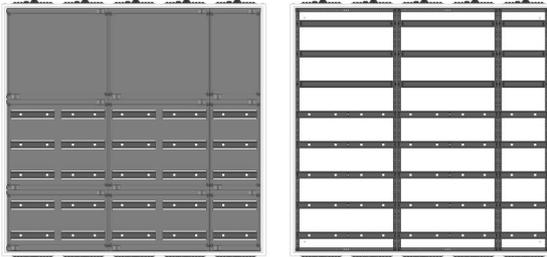
AVB5-8-210-S-PAutomatenverteiler, AVB, BxHxT = 1300x1250x210Schutzklasse I, IP41, RAL 9016, AufputzBestehend aus:Gehäuse, Doppeltür mit Drehriegel, Flansche NF1 (oben) und NF2 (unten), 2x Geräteträger 2-Feld breit 3/5 mit Feldabdeckungen PS, 1x Geräteträger 1-Feld breit 3/5 mit Feldabdeckungen PS
