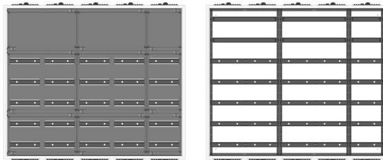
AVB5-7-210-S-PAutomatenverteiler, AVB, BxHxT = 1300x1100x210Schutzklasse I, IP41, RAL 9016, AufputzBestehend aus:Gehäuse, Doppeltür mit Drehriegel, Flansche NF1 (oben) und NF2 (unten), 2x Geräteträger 2-Feld breit 2/5 mit Feldabdeckungen PS, 1x Geräteträger 1-Feld breit 2/5 mit Feldabdeckungen PS
