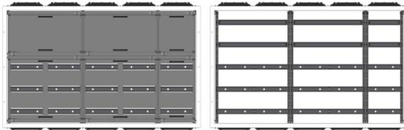
AVB5-5-360Automatenverteiler, AVB, BxHxT = 1320x820x360Schutzklasse I, IP54, RAL 7035, AufputzBestehend aus:Gehäuse, Einzeltür mit Schwenkhebel für PHZ, Flansche SF35 (oben) und SF32 (unten), 1x Geräteträger 3-Feld breit + 1x Geräteträger 2-Feld breit je 2/3 mit Feldabdeckungen PRL
