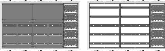
AVB5-5-230-M1-PAutomatenverteiler, AVB, BxHxT = 1300x800x230Schutzklasse I, IP54, RAL 7035, AufputzBestehend aus:Gehäuse, Doppeltür mit Schwenkhebel für PHZ, Flansche SF45 (oben) und SF41 (unten), 2x Geräteträger 2-Feld breit 2/3 mit Feldabdeckungen PS, 1x Montageplatte 1-Feld breit
