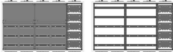
AVB5-5-210-M1-PAutomatenverteiler, AVB, BxHxT = 1300x800x210Schutzklasse I, IP41, RAL 9016, AufputzBestehend aus:Gehäuse, Doppeltür mit Drehriegel, Flansche NF1 (oben) und NF2 (unten), 2x Geräteträger 2-Feld breit 2/3 mit Feldabdeckungen PS, 1x Montageplatte 1-Feld breit
