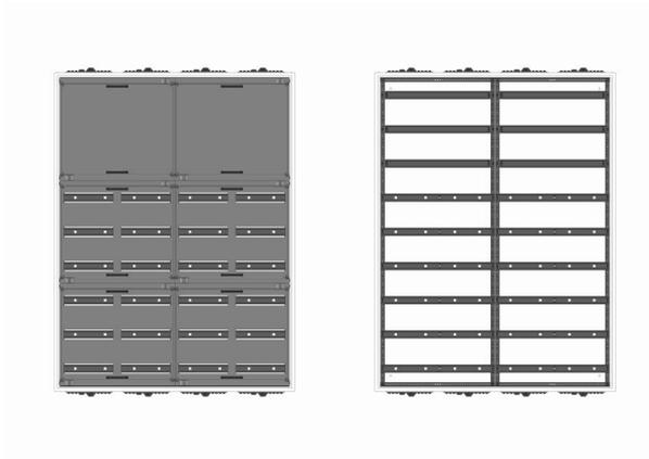
AVB4-9-230 Automatenverteiler, AVB, BxHxT = 1050x1400x230 Schutzklasse I, IP54, RAL 7035, Aufputz
