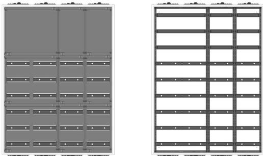
AVB4-9-230-S-PAutomatenverteiler, AVB, BxHxT = 1050x1400x230Schutzklasse I, IP54, RAL 7035, AufputzBestehend aus:Gehäuse, Doppeltür mit Schwenkhebel für PHZ, Flansche SF45 (oben) und SF41 (unten), 1x Geräteträger 2-Feld breit 3/6 mit Feldabdeckungen PS, 2x Geräteträger 1-Feld breit 3/6 mit Feldabdeckungen PS
