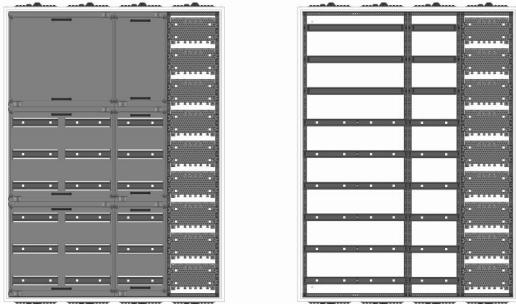
AVB4-9-230-M1 Automatenverteiler, AVB, BxHxT = 1050x1400x230 Schutzklasse I, IP54, RAL 7035, Aufputz
