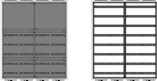
AVB4-8-230-PAutomatenverteiler, AVB, BxHxT = 1050x1250x230Schutzklasse I, IP54, RAL 7035, AufputzBestehend aus:Gehäuse, Doppeltür mit Schwenkhebel für PHZ, Flansche SF45 (oben) und SF41 (unten), 2x Geräteträger 2-Feld breit 3/5 mit Feldabdeckungen PS
