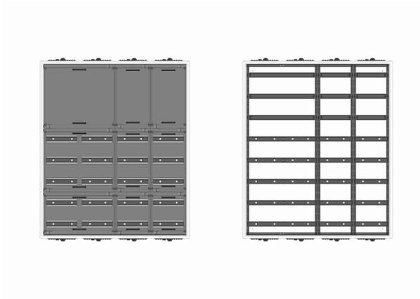
AVB4-8-210-S Automatenverteiler, AVB, BxHxT = 1050x1250x210 Schutzklasse I, IP41, RAL 9016, Aufputz
