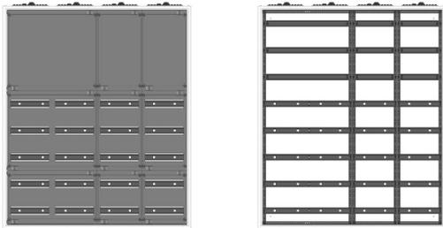
AVB4-8-210-S-PAutomatenverteiler, AVB, BxHxT = 1050x1250x210Schutzklasse I, IP41, RAL 9016, AufputzBestehend aus:Gehäuse, Doppeltür mit Drehriegel, Flansche NF1 (oben) und NF2 (unten), 1x Geräteträger 2-Feld breit 3/5 mit Feldabdeckungen PS, 2x Geräteträger 1-Feld breit 3/5 mit Feldabdeckungen PS
