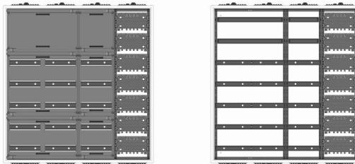
AVB4-7-230-M1 Automatenverteiler, AVB, BxHxT = 1050x1100x230 Schutzklasse I, IP54, RAL 7035, Aufputz
