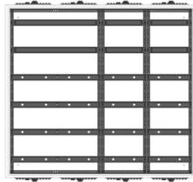
AVB4-6-230-S-PAutomatenverteiler, AVB, BxHxT = 1050x950x230Schutzkasse I, IP54, RAL 7035, AufputzBestehend aus:Gehäuse, Doppeltür mit Schwenkhebel für PHZ, Flansche SF45 (oben) und SF41 (unten), 1x Geräteträger 2-Feld breit 2/4 mit Feldabdeckungen PS, 2x Geräteträger 1-Feld breit 2/4 mit Feldabdeckungen PS
