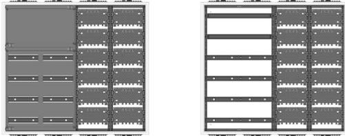
AVB4-6-230-M2-PAutomatenverteiler, AVB, BxHxT = 1050x950x230Schutzklasse I, IP54, RAL 7035, AufputzBestehend aus:Gehäuse, Doppeltür mit Schwenkhebel für PHZ, Flansche SF45 (oben) und SF41 (unten), 1x Geräteträger 2-Feld breit 2/4 mit Feldabdeckungen PS, 1x Montageplatte 2-Feld breit
